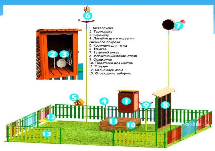
Флюгер в форме вращающегося на опорной оси «петушка» позволяет наглядно показывать направление ветра по размещенному неподвижно у его основания указателю сторон света.
